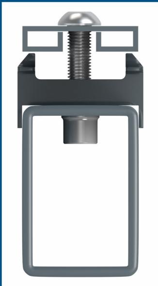
Ansicht Querschnitt Profilrohrpfosten
